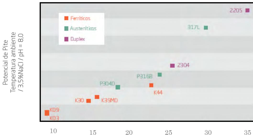
Os altos índices de cromo, nitrogênio e molibdênio tornam o duplex 2205 uma excelente alternativa quanto à resistência a corrosão por pites, sua performance inclusive é superior ao AISI 304L e ao 316L.
